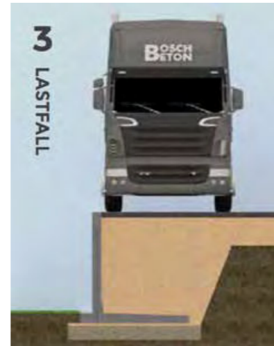
Geeignet für Verkehrslast SLW30 (max. 16,67 kN/m 2 ). Kein Randabstand.
